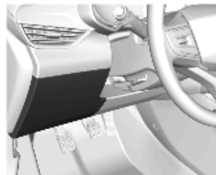
Блок предохранителей в приборной панели
